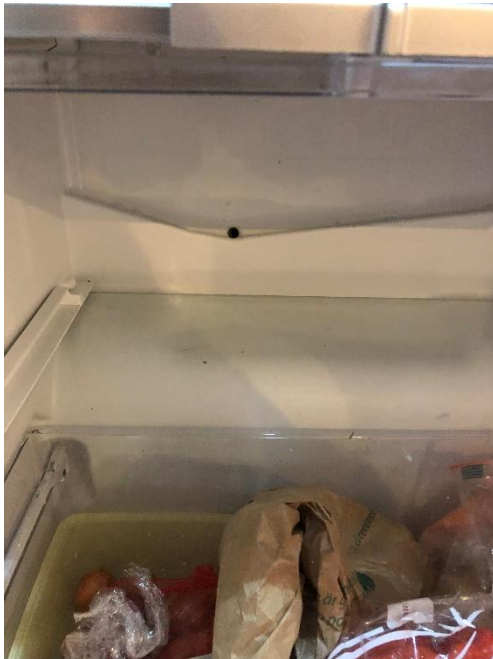
Här sitter dräneringskanalen inne i kylskåpet
